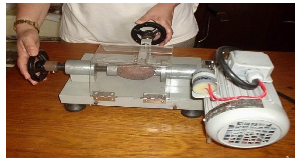
Figura 1 - Protótipo para extração de amêndoa de castanha-de-cutia (Foto do Autor).
