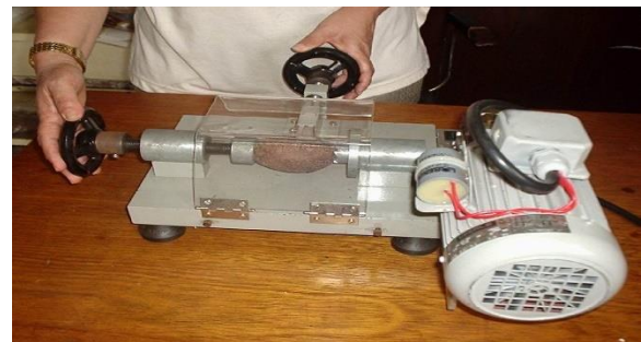
Figura 1 - Protótipo para extração de amêndoa de castanha-de-cutia (Foto do Autor).
