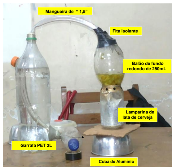
Figura 2: Destilador caseiro usado no experimento. Adaptado de Rubinger e Braathen (2012)
