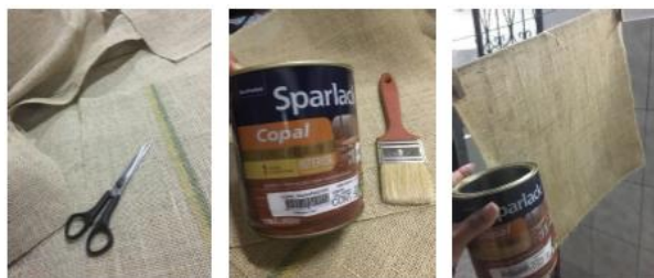
Figura 3 – Preparo e tratamento com verniz (Tratamento Polimérico) do tecido de fibras. Fonte: Autor
