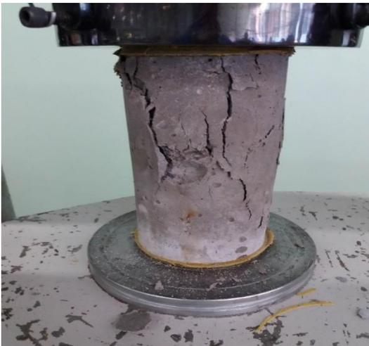
Figura 3: Corpos de prova, de traço industrial, após a ruptura.
