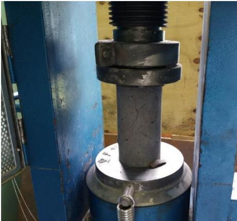
Figura 2: Corpo de prova, de traço experimental, após ruptura.
