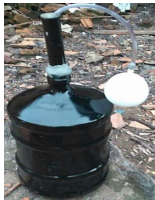
Figura 2. Biodigestor Completamente Montado.
