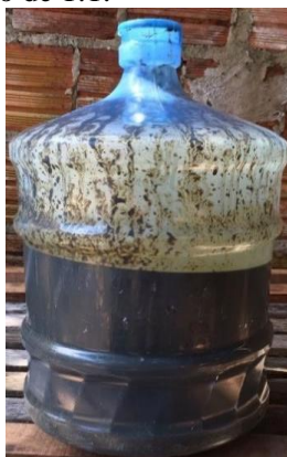
Figura 1. Biodigestor Preenchido Com Biomassa e Água.
