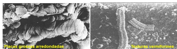
Figura 14: Micrografias obtidas através do MEV da caulinita pura. FONTE: APARÍCIO et al. (2009) e EKOSSE (2010).
