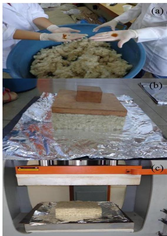
Figura 3. (a) Mistura da resina nas fibras; (b) Formação do Colchão; (c) Prensagem a quente.
