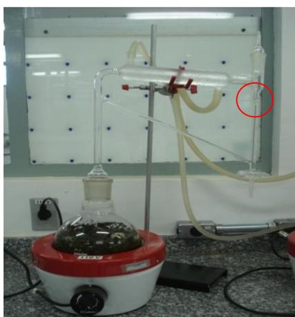
Figura 1. Sistema de Clevenger utilizado para extração das 4 amostras de *Protium*
