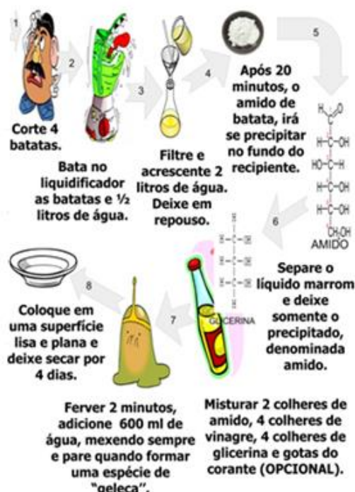
Figura 4: Fluxograma linear, processo de construção de plástico através de amido de batata. FONTE: Acervo próprio, 2017.
