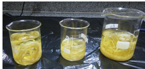
Figura 9: Tratamento químico das fibras com hidróxido de sódio.
