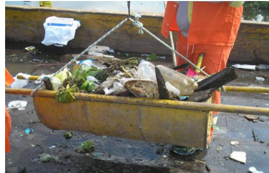
Figura 2: Pesagem de padiola com resíduos retirados do montante acumulado na balsa, para formação da amostra para análise semigravimétrica em trecho do igarapé do São Raimundo (26/07/2016)
