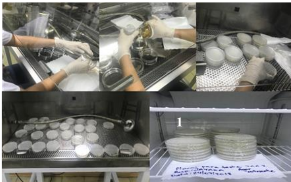
Figura 4 - Preparo das placas com ágar nutriente: (1) transferência da solução autoclavada para capela esterilizada, (2) distribuição de aproximadamente 10 mL ainda quente, para as placas estéreis, (3) homogeneização do meio na placa, (4) gelificação e (5) acondicionamento das placas invertidas na geladeira.
