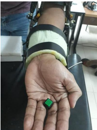
Figura 33 – Exoesqueletovistafrental. Posicionamento do botão de acionamento na palma da mão do usuário
