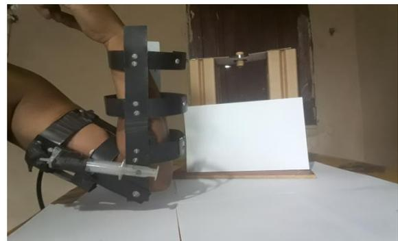
Figura 12 - Atuação baseada na sucção de ar (Força). Braço na posição 90°
