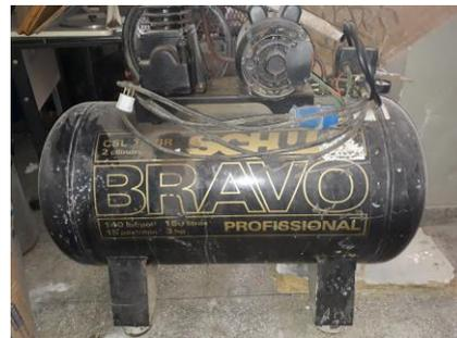
Figura 18 - Compressor 180 litros, utilizado para testes com músculos artificiais
