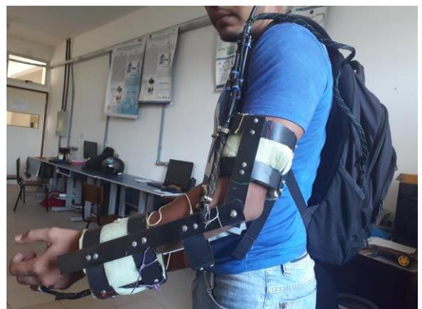
Figura 34 – A imagem exibe o Exoesqueleto Sansão em fase final de desenvolvimento, onde é possível observar a adaptação realizada utilizando uma mochila para melhor desempenho.
