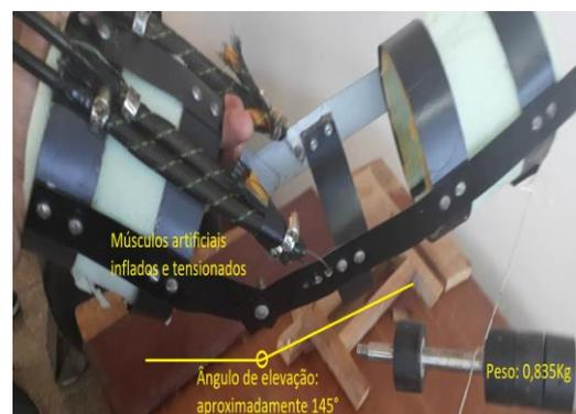
Figura 22 – Estado de atuação final, onde é possível observar o exoesqueleto erguer sozinho à aproximadamente 35° do estado inicial, o peso de 0,835 Kg
