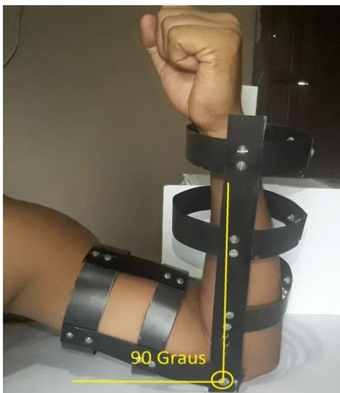
Figura 7 – Utilização de ferramenta realizando um movimento de 90°
