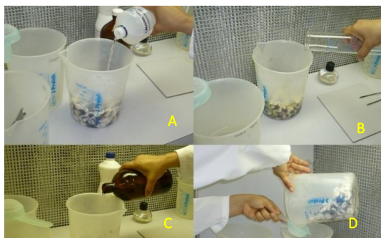
Figura 3 - Assepsia dos explantes em câmara de fluxo laminar: (A) Lavagem em álcool 70%; (B) Imersão em solução de hipoclorito de sódio a 2% de cloro ativo; (C e D) enxágue em água destilada autoclavada.
