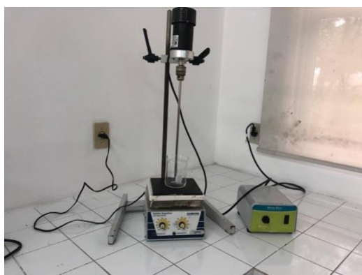
Figura 5 – Sistema para troca iônica bentonita sódica e bentonita cálcica (representação para um ponto)
