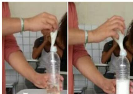
Figura 1: Enchendo o balão a partir da reação do vinagre com o bicarbonato de sódio
