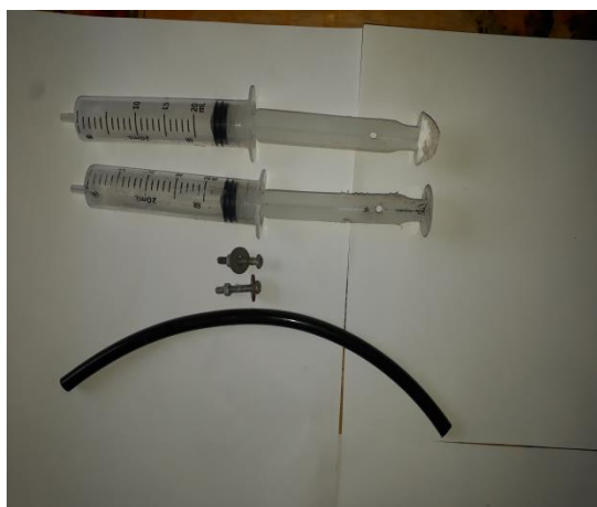
Figura 10 - Instalação de seringas para simulação de atuadores pneumáticos
