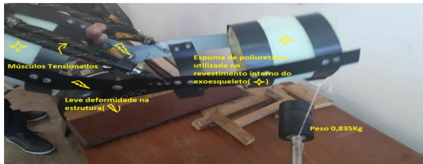
Figura 23 - A figura mostra o exoesqueleto em funcionamento, músculos inflados e tensionados, suportando um peso de 0,835 Kg. É possível observar as deformidades e o revestimento de poliuretano
