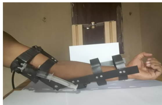
Figura 13 - Atuação baseada na compressão de ar (Repouso). Braço na posição 180°
