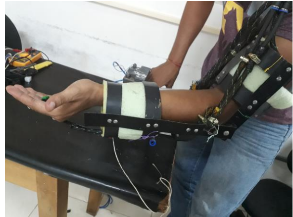
Figura 32 – Exoesqueleto vista lateral. O botão de ativação foi posicionado no exoesqueleto de forma a não impedir a movimentação, encaixando-se na mão do usuário
