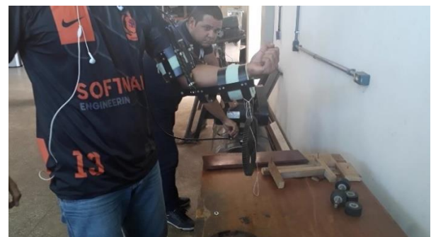
Figura 26 - Peso sendo de 2,420 Kg sendo levantado pelo usuário com auxílio do exoesqueleto
