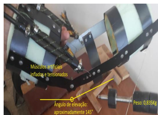
Figura 22 – Estado de atuação final, onde é possível observar o exoesqueleto erguer sozinho à aproximadamente 35° do estado inicial, o peso de 0,835 Kg
