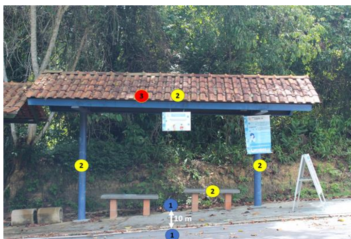
Figura 4 - Esquematização das medições da parada modelo 2. (1) Termo-higrômetro digital HM-350, (2) Termômetro Digital Infravermelho Incoterm Scan Temp ST-600, (3) Câmera Termográfica Profissional Flir T420. Fonte: Autoria própria (2021).
