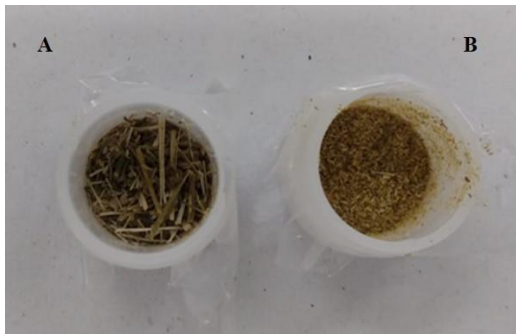
Figura 1 - Amostras de camomila preparado para à análise de Fluorescência de Raios-X por Energia Dispersiva (EDXRF). A) amostra vegetal de camomila com a presença de estruturas rígidas, como: caule e pedúnculo floral; B) amostra vegetal de camomila pulverizada.
